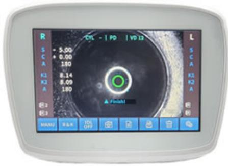
Efetue simultaneamente as medidas de refração e ceratometria ou opte fazê-las separadamente.
