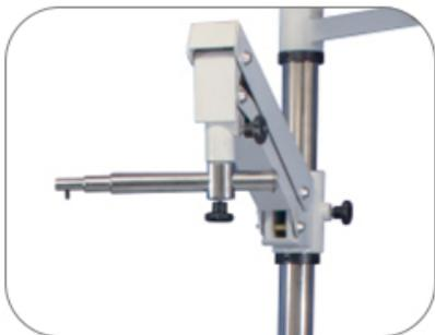
Braço pantográfico com controle de estabilidade e peso do greens.
