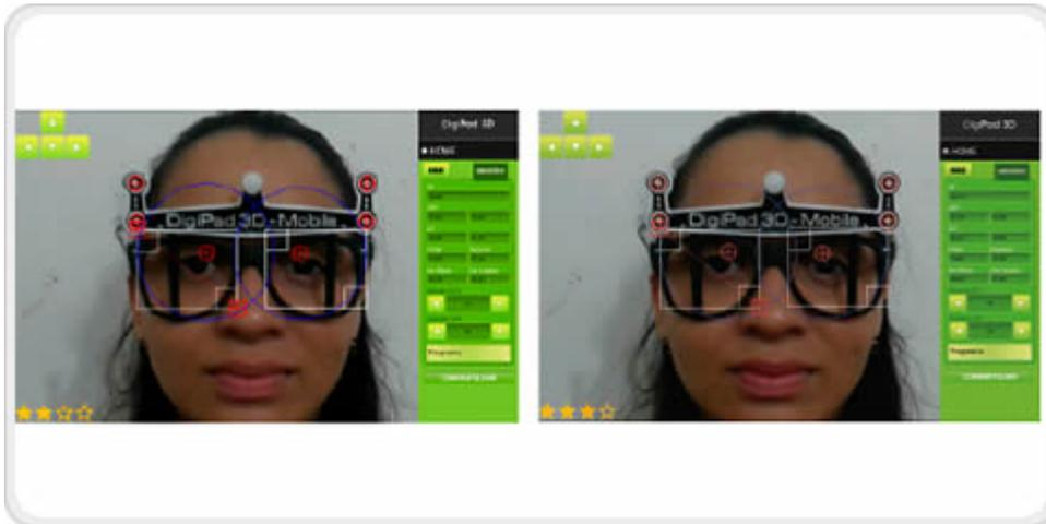
Nesta parte do módulo através da RÉGUA de CENTRALIZAÇÃO é possível em uma ÚNICA medição obter: DP, DNP e Altura; além de medidas Ponte. Aro, Diagonal, entre outras. Nova função que auxilia na tirada das medidas, através de uma escala de estrelas. O Digipad informa se o vendedor fez uma medida de boa qualidade ou não, para que você sempre tenha uma medição precisa.
