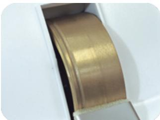
Ampla rebolo com duas pistas de granulações diferentes para melhor acabamento e pista de ringles.
