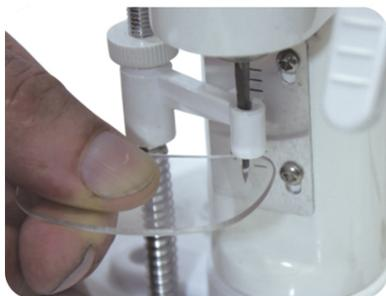
Regulador de espessura do furo da lente através de barra milimetrada.
