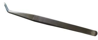
Pinça utilizada para auxiliar em trabalho de solda de armação
